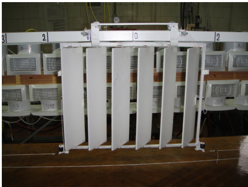
Рис. 3. Макет подвесной парусной энергетической установки.
