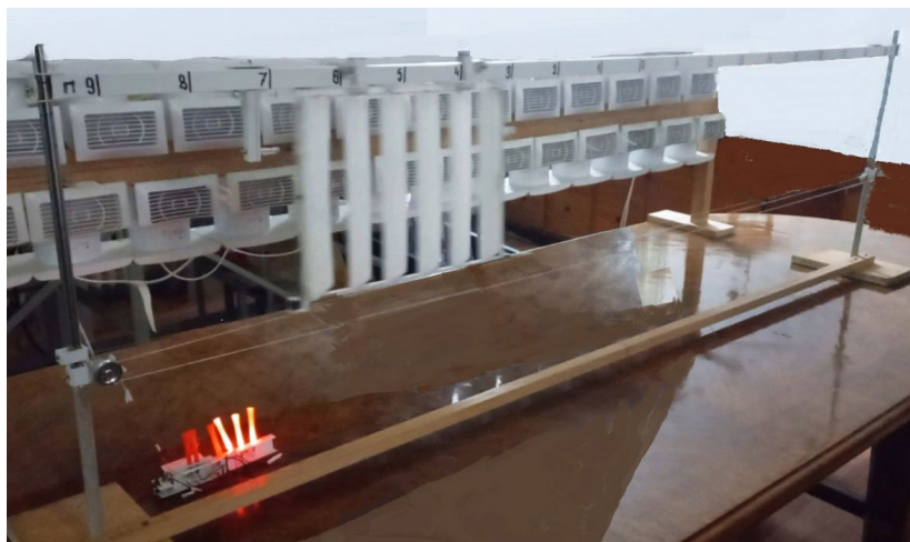
Рис. 8. Иллюстрация возможности подвесной парусной энергетической установки вырабатывать электроэнергию на примере работы светодиодов.
