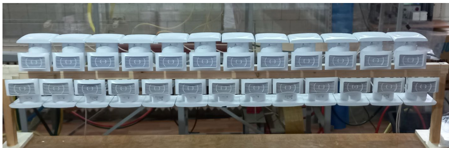
Рис. 1. Генератор ветрового потока.
