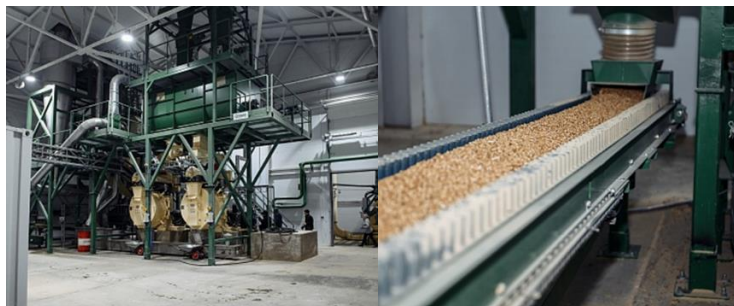
Рис. 6. Установка по производству пеллет [12]
