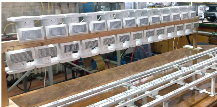
Рис. 1. Генератор ветрового потока (верхняя часть снимка) и эстакады для движения платформ (на переднем плане, внизу).
