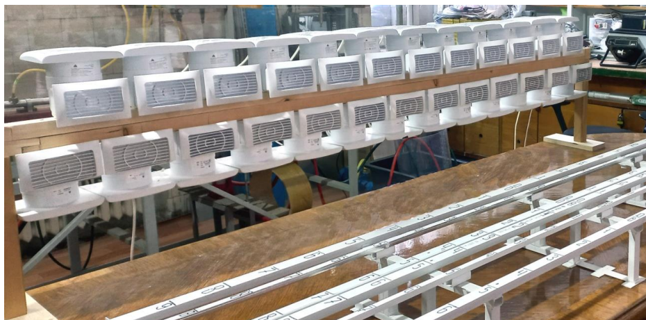
Рис. 1. Генератор ветрового потока и эстакады для движения платформ
