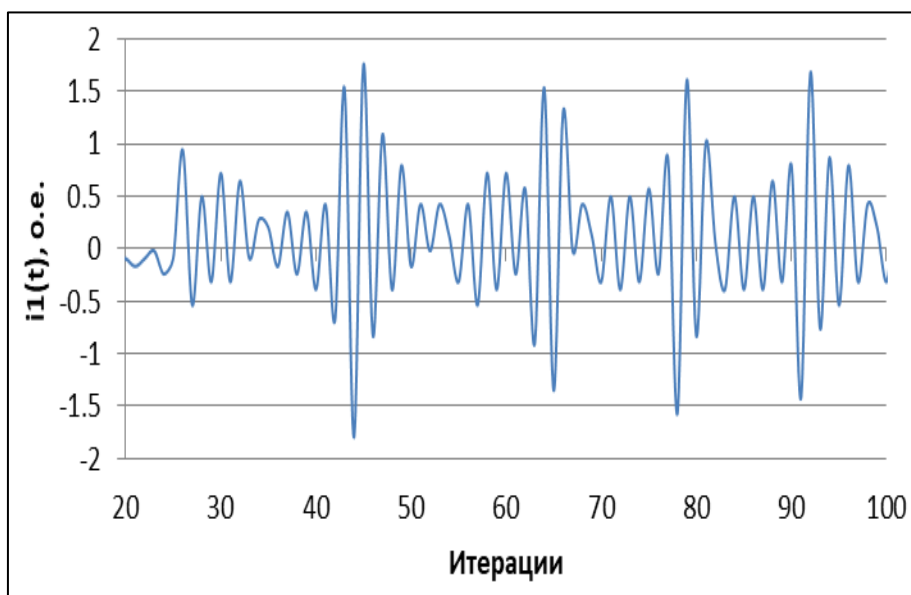
Рис. 6. Мгновенные значения тока i_1 при запуске насоса «Малыш»
