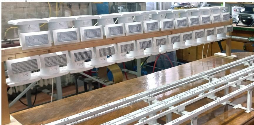
Рис. 1. Генератор ветрового потока (на заднем фоне) и эстакады.
