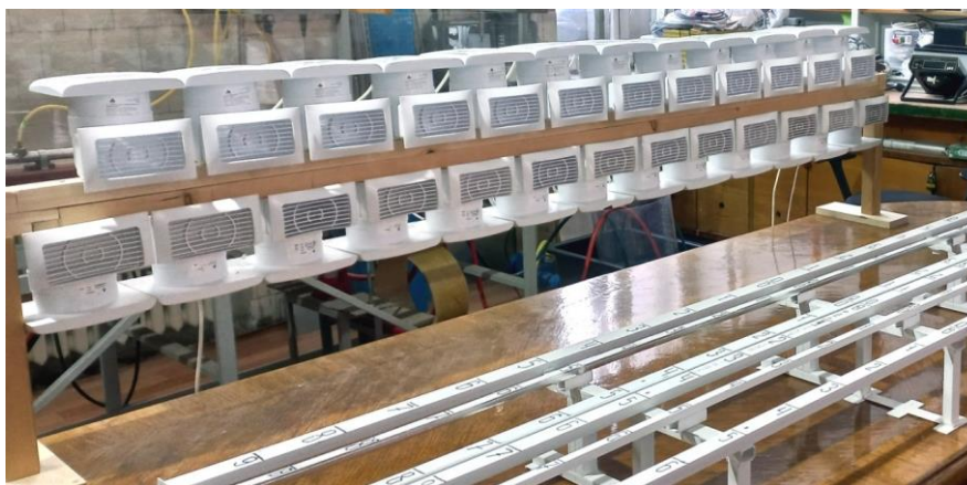
Рис. 1. Генератор ветрового потока.
