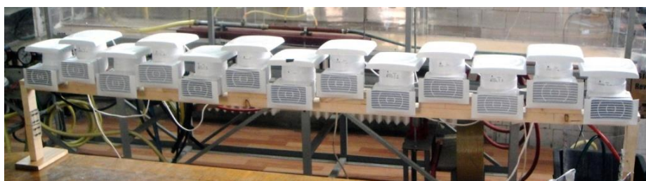
Рис. 1. Генератор ветрового потока
