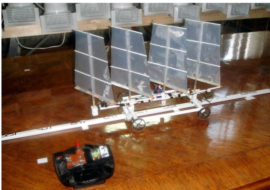
**Рис. 2.** Платформа с парусами на направляющем рельсе. Устройство радиуправления на переднем плане
