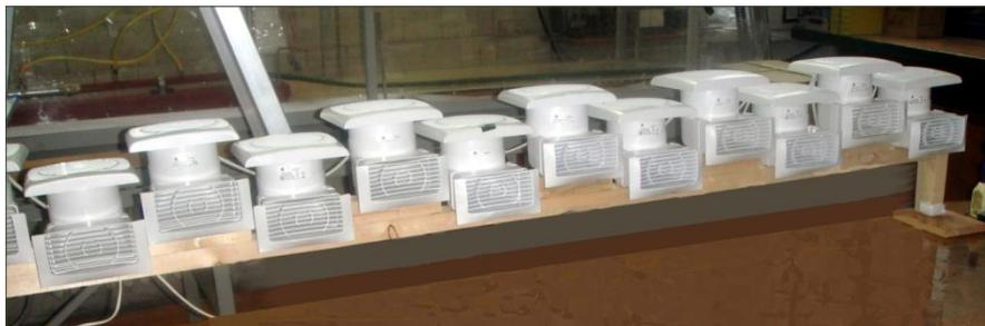
**Рис. 1.** Генератор ветрового потока
