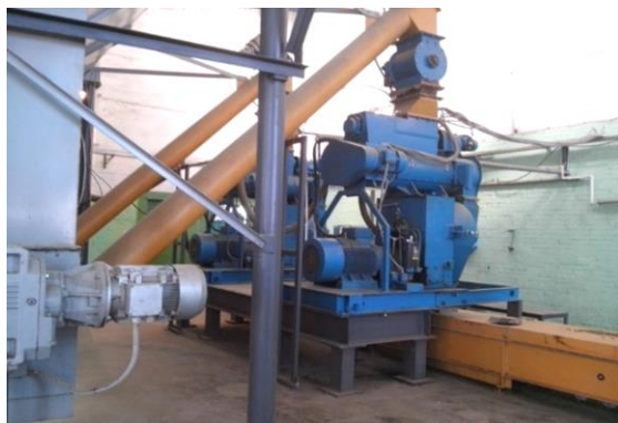
Рис. 16. Приёмный бункер исходного сырья и промежуточный накопитель. Источник: фото авторов.
