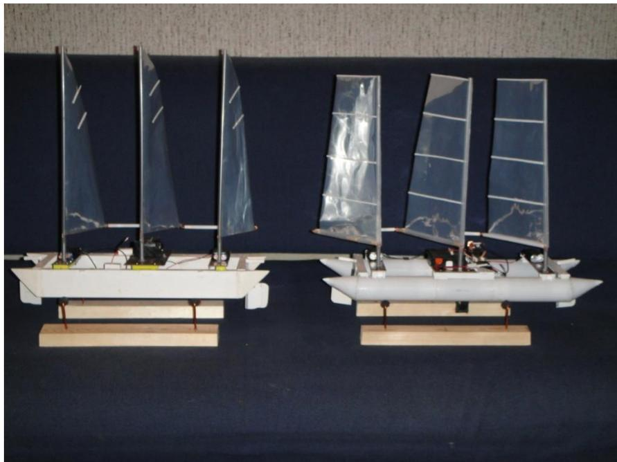
**Рис. 1.**Изображения второго (слева) и третьего (справа) вариантов макета парусной энергетической установки
