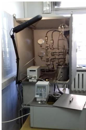
Рис. 4. Установка для измерения изотерм сорбции – десорбции водорода. Фото К.С. Дегтярева
