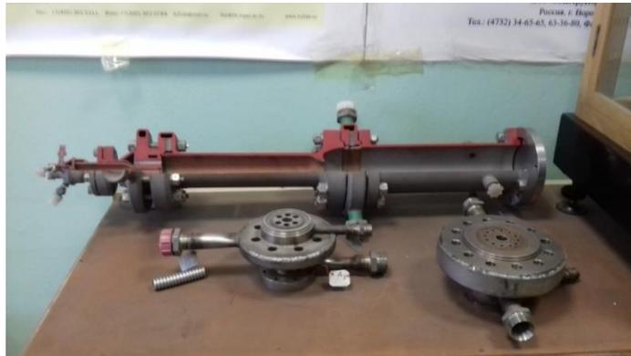
Рис. 5. Водородно-кислородный парогенератор мощностью 20 МВт. Разработка Лаборатории водородных энергетических технологий ОИВТ РАН. Фото К.С. Дегтярева
