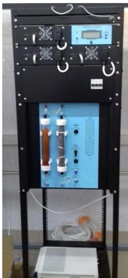
Рис. 2. Лабораторное устройство для электролиза отечественного производства, производительностью 300 л/час. Фото К.С. Дегтярева
