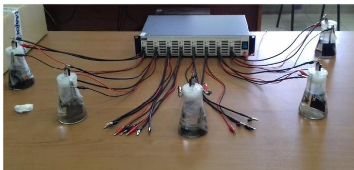
Рис. 3. Металлогидридный аккумулятор. Фото К.С. Дегтярева
