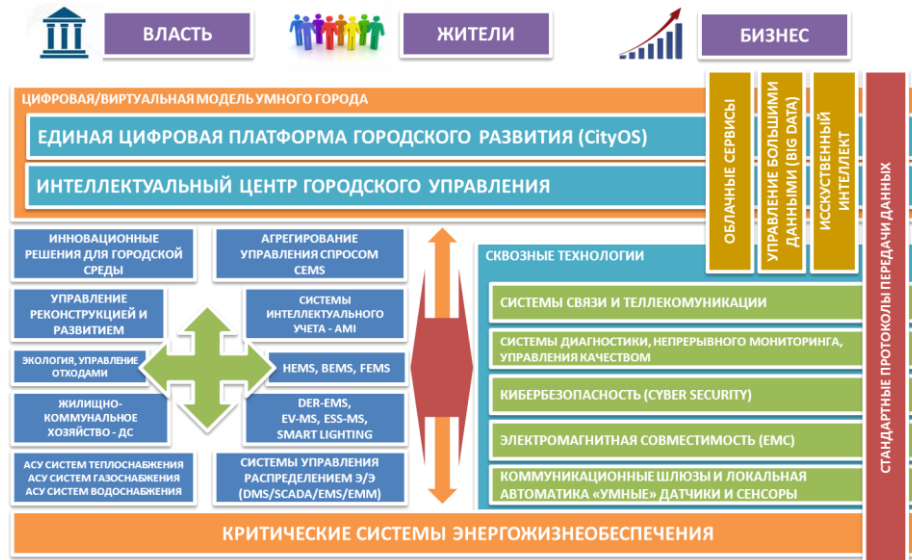
Рис. 6. Пример концептуальной архитектуры управления «Smart City»
