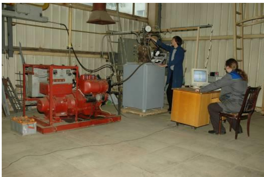
Рис. 7. Демонстрационная установка для совместного производства электрической и тепловой энергии, работающая на продуктах переработки биомассы на примере древесных отходов и торфа
